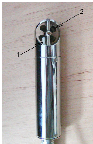
Rys. 13.4. Widok sondy pomiarowej: 1 – czujnik temperatury, 2 – skrzydełkowy wiatraczek pomiarowy
