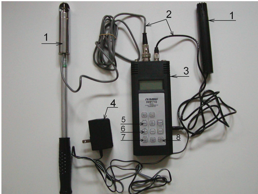
Rys. 13.3. Widok zestawu anemometru : 1 - teleskopowa sonda pomiarowa, z lewej do pomiaru prędkości i temperatury, z prawej do pomiaru temperatury i wilgotności powietrza, 2 – przewody sygnałowe, 3 - termo – hydro anemometr cyfrowy, 4 – zasilacz, 5 – przycisk odczytu wilgotności powietrza, 6 – przycisk opcji zmiany jednostki temperatury, 7 – przycisk opcji zmiany jednostki prędkości
