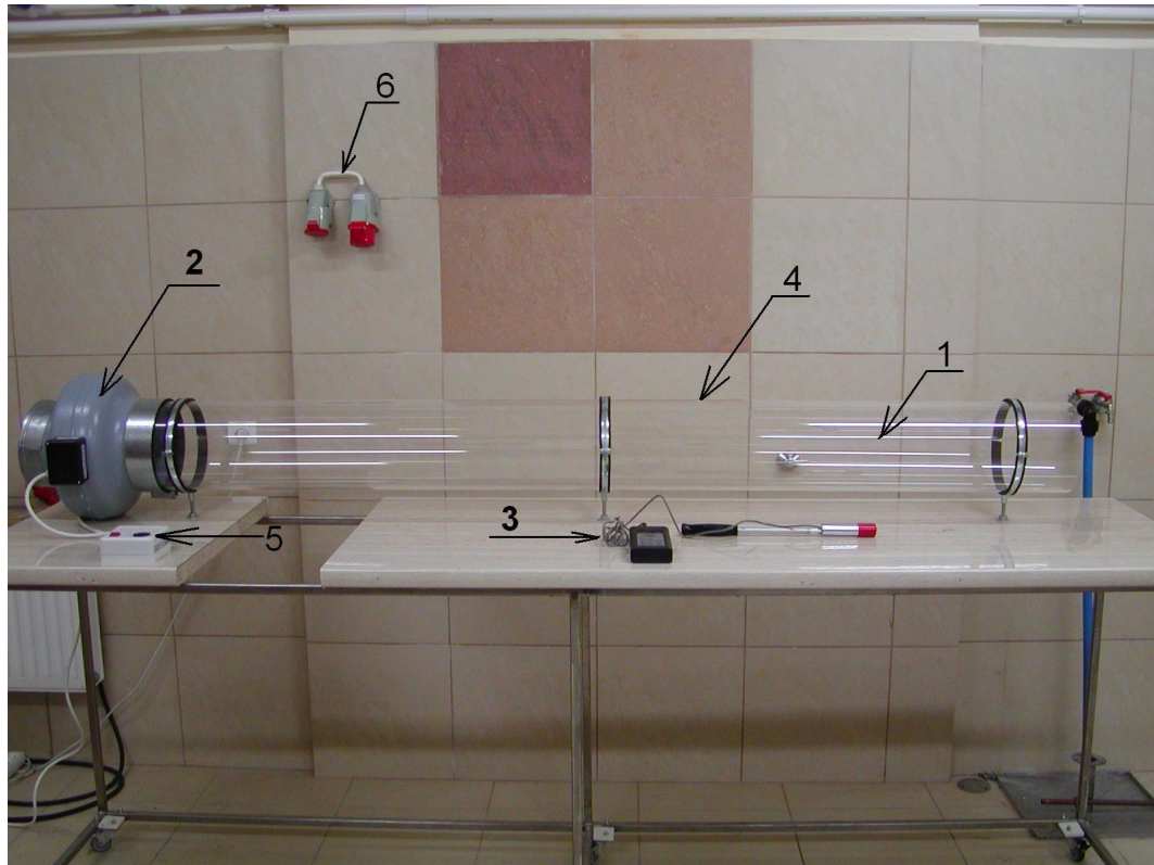
Rys. 13.2. Widok stanowiska do pomiaru prędkości powietrza w przewodzie: 1 – przewód kołowy z tworzywa sztucznego \phi = 200\text{mm} , 2 wentylator wywiewny, 3 – anemometr cyfrowy z sondą pomiarową, 4 – otwór pomiarowy do anemometru, 5 – wyłącznik i sterowni obrotów, 6 – gniazdo instalacji elektrycznej
